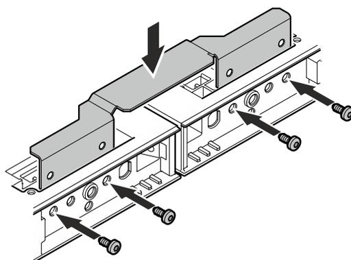
Kątownik łączący zamontować od góry i przykręcić za pomocą czterech śrub M5 x 10 (TX 25).
