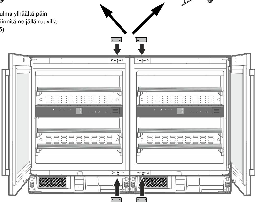
7. Aseta toinen liitântäkulma (ilman kiinnityskielekettä) alhaalta päin paikalleen ja kiinnitä neljällä ruuvilla M5 x 10 (TX 25).
