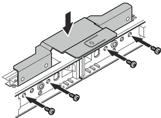
**Bij werkbladen van niet schroefbaar materiaal (bijv. steen)**
