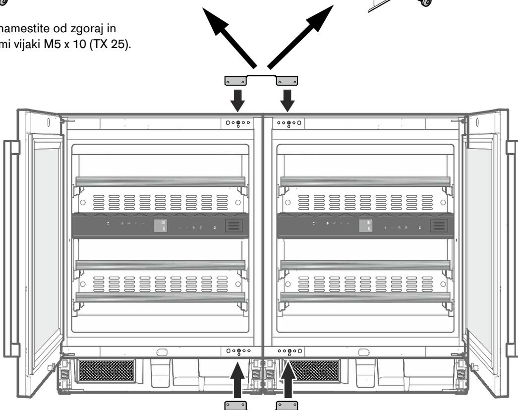
7. Drugi spojni kotnik (brez pritrdilne zaplate) namestite od spodaj in ga pritrdite s štirimi vijaki M5 x 10 (TX 25).
