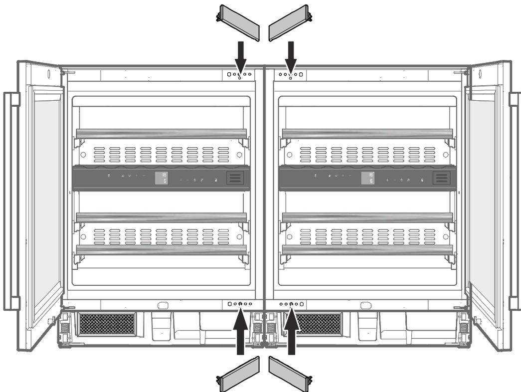
9. Skjut in enhetskombinationen i nischen så att framkanten på enheternas luckor är kant i kant med stomfronterna.
