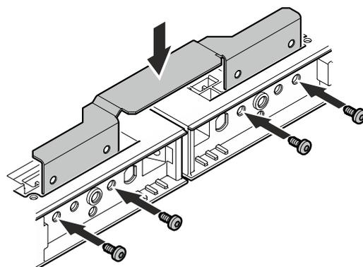
Aseta liitântäkulma ylhäältä päin paikalleen ja kiinnitä neljällä ruuvilla M5 x 10 (TX 25).
