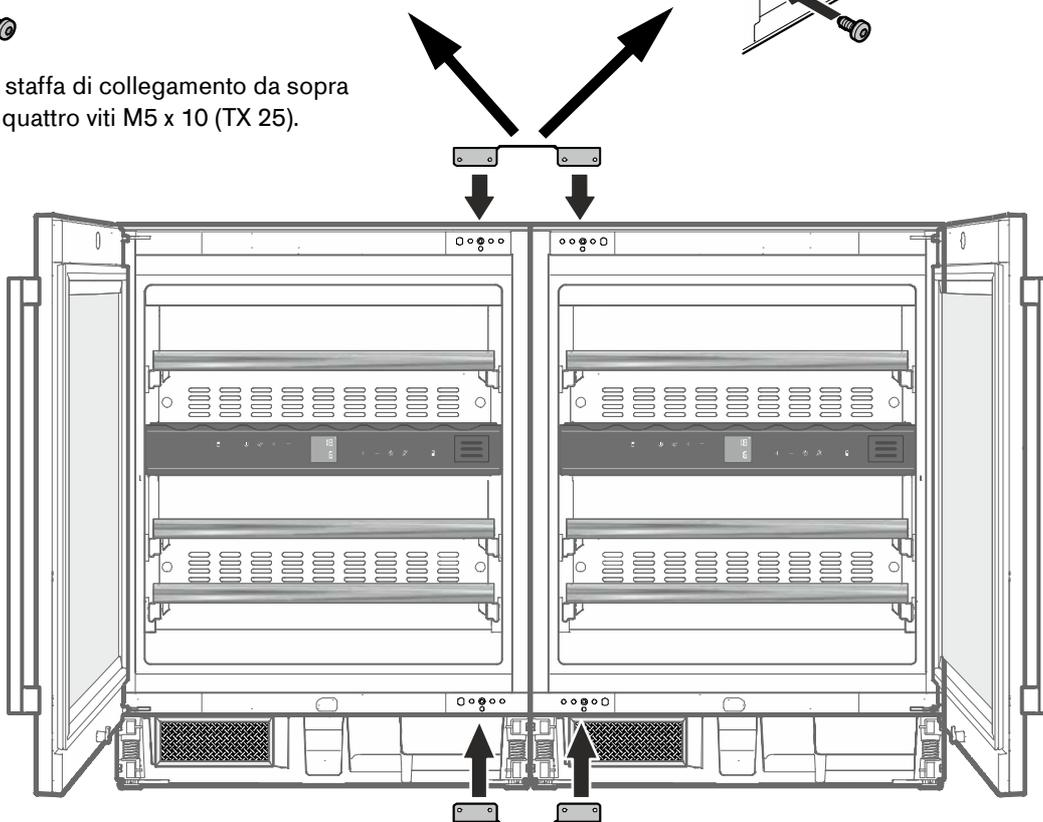
7. Posizionare la seconda staffa di collegamento (senza linguetta di rinforzo) dalla parte inferiore e avvitare con quattro viti M5 x 10 (TX 25).
