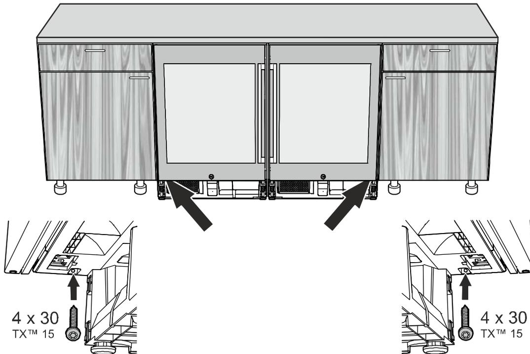
11. Jos työtasot ovat puuta, kiinnitä laiteyhdistelmä syvennykseen ylhäältä.
