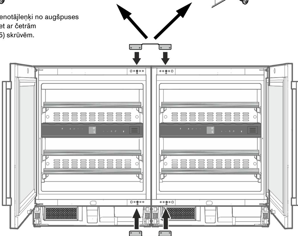
7. Ievietojiet otru savienotājleņķi (bez stiprinājuma balsteņa) no apakšpusē un pieskrūvējiet ar četrām M5 x 10 (TX 25) skrūvēm.
