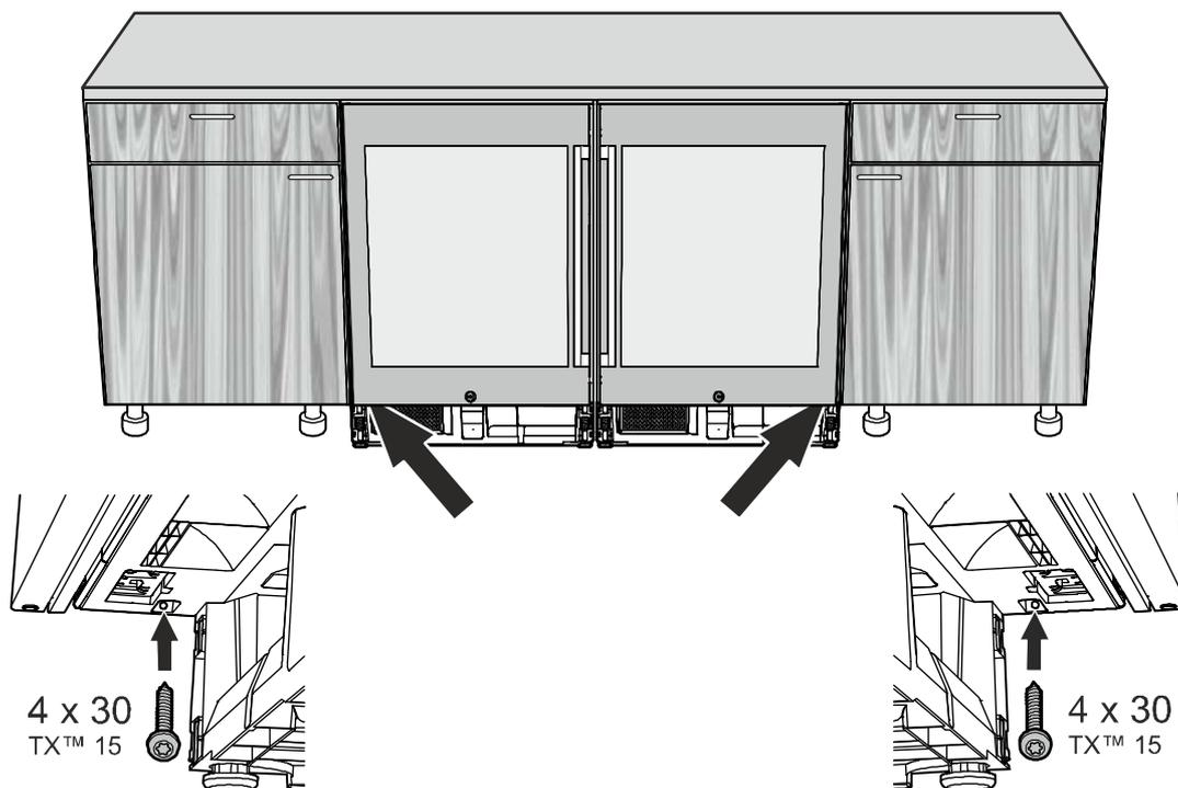
11. При встановленні під дерев'яною стільницею закріпіть з'єднані прилади в ніші вгорі.
