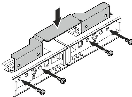
Posizionare la staffa di collegamento da sopra e avvitare con quattro viti M5 x 10 (TX 25).
