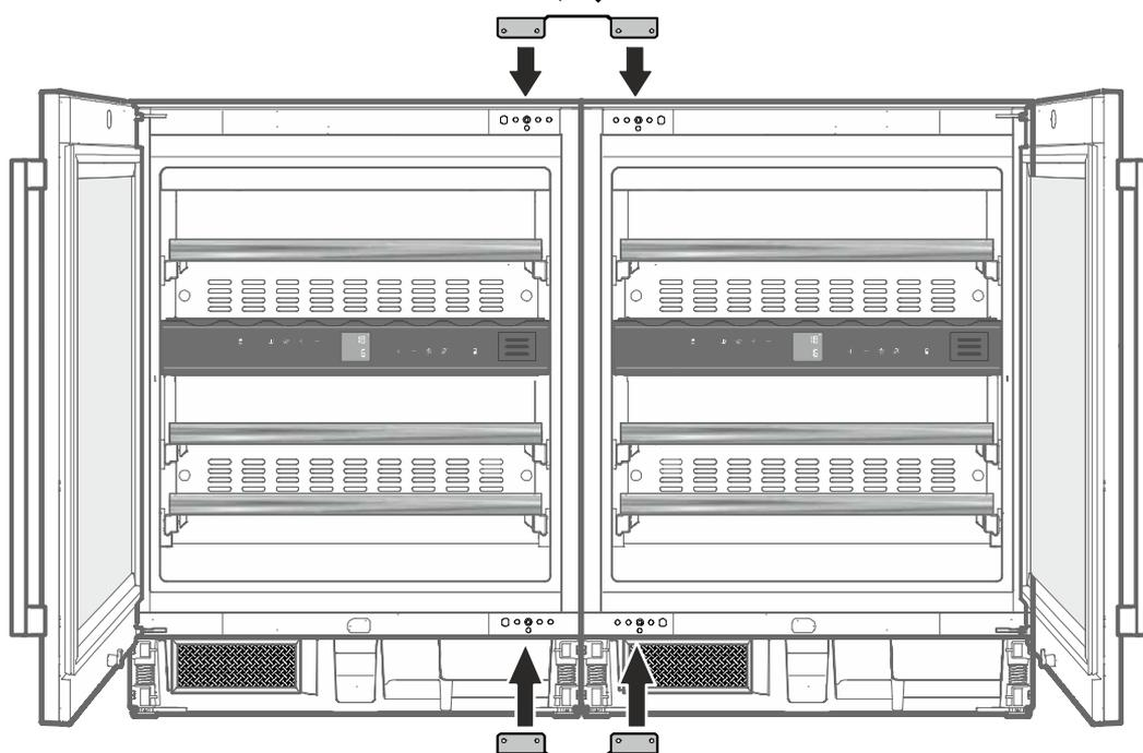
7. Другий з'єднувальний косинець (без кріпильної накладки) встановіть знизу та пригвинтіть чотирма гвинтами М5 х 10 (ТХ 25).
