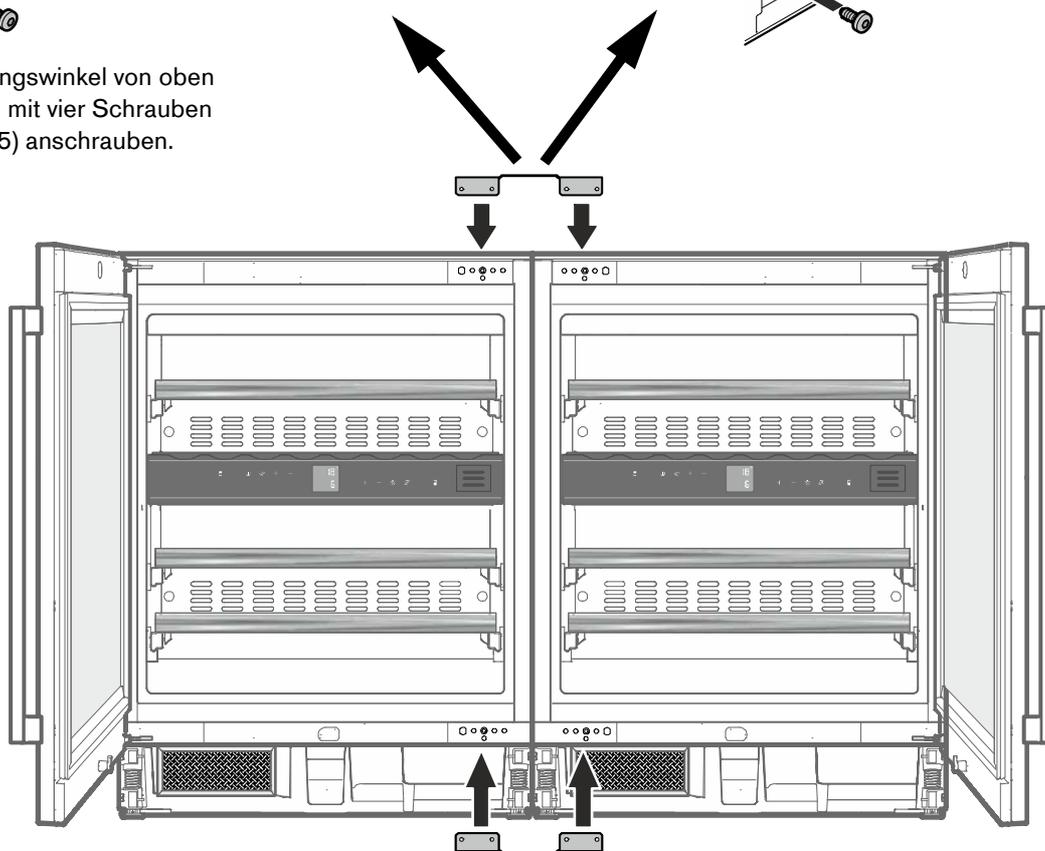
7. Den zweiten Verbindungswinkel (ohne Befestigungslasche) von unten einsetzen und mit vier Schrauben M5 x 10 (TX 25) anschrauben.
