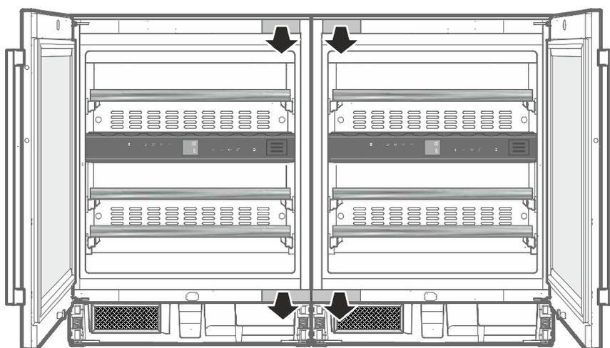
6. Verbindungswinkel oben einsetzen.
