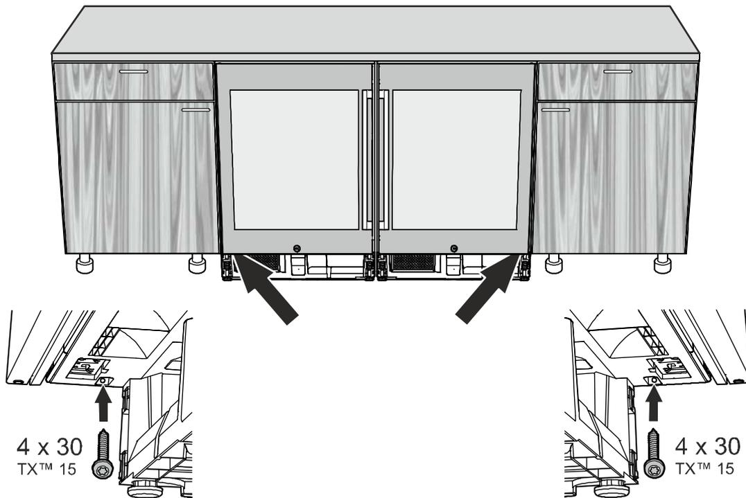
11. Bei Arbeitsplatten aus Holz die Gerätekombination in der Nische oben befestigen.
