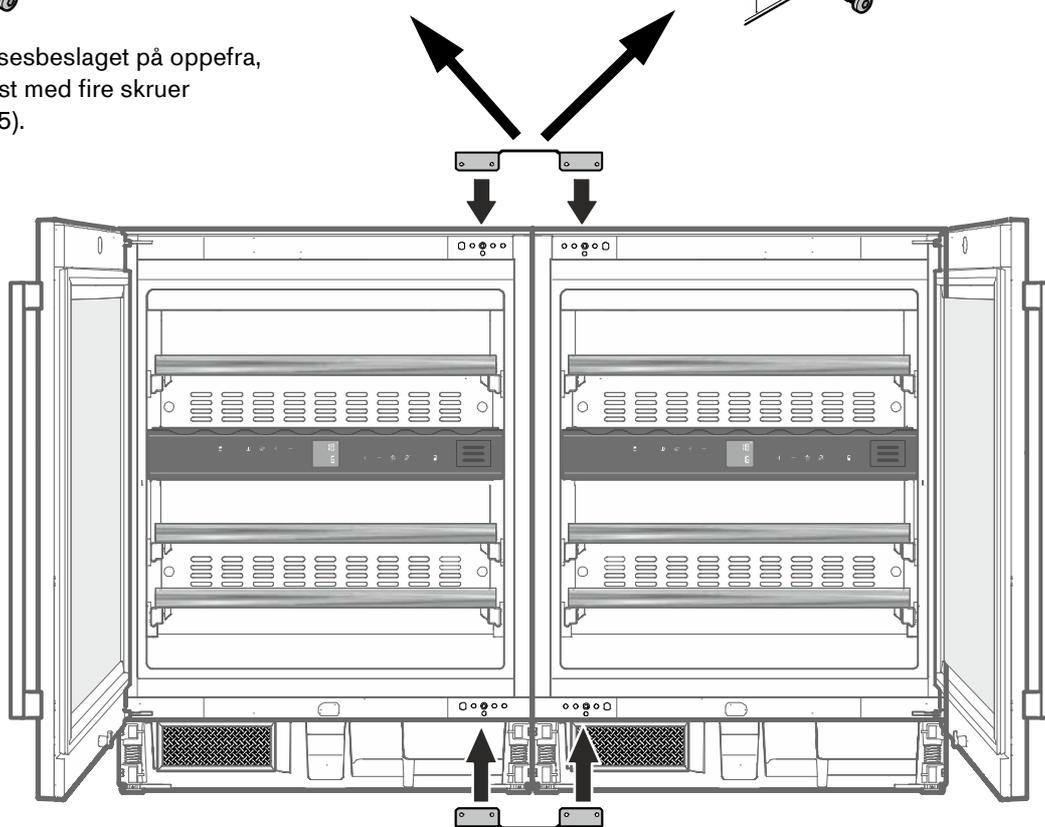
7. Sæt det andet forbindelsesbeslag (uden befæstigelseslaske) på nedefra, og skru det på med fire skruer M5 x 10 (TX 25).
