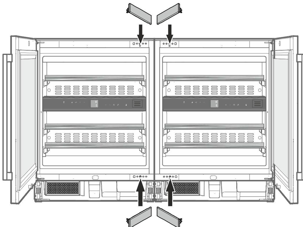
9. Вставьте комбинацию приборов в нишу так, чтобы передняя поверхность дверец прибора оказалась на одной линии с фасадом мебели.
