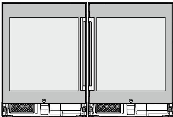
3. Novietojiet ierīces vienādā augstumā un horizontāli.
