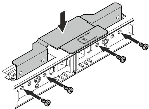
**Для столешниц из материала, не рассчитанного на винтовое крепление (например, из камня)**
