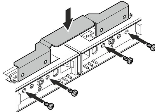
De bevestigingshoek van boven er in brengen en met vier schroeven M5 x 10 (TX 25) vastschroeven.
