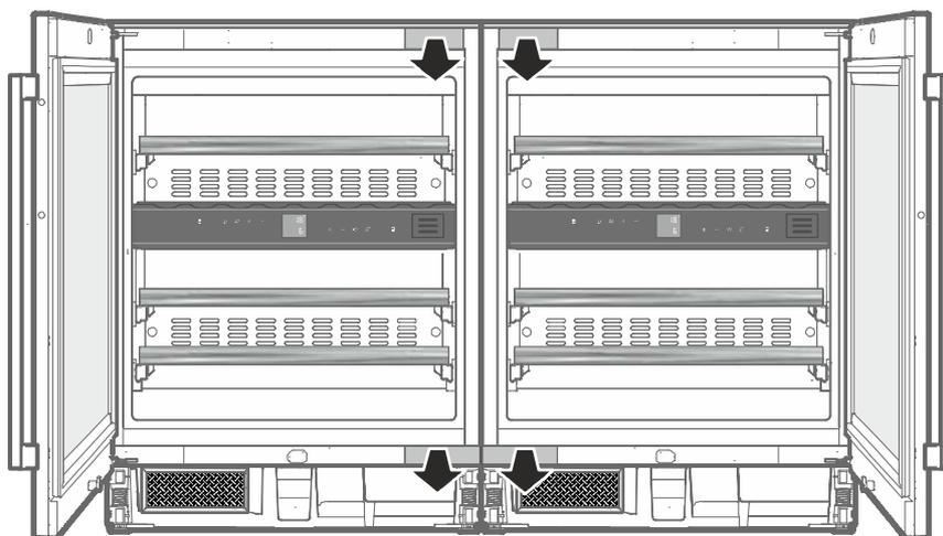
6. Posizionare la staffa di collegamento sulla parte superiore.
