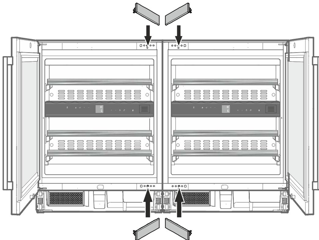
9. Die Gerätekombination in die Nische einschieben, bis die Vorderfläche der Gerätetüren mit den Möbelfronten bündig ist.
