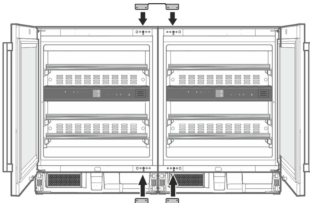
7. Sätt i den andra fästvinkeln (utan fästdel) underifrån och skruva fast med 4 st. M5 x 10-skruv (TX 25).
