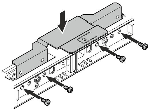
**Kai darbinės plokštės iš nesuveržiamos varžtais medžiagos (pvz., akmuo)**
