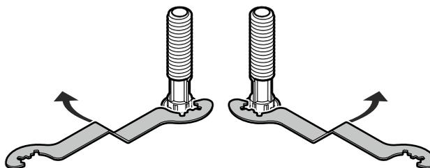
4. Skruva fast enheterna baktill med fästvinklarna.
