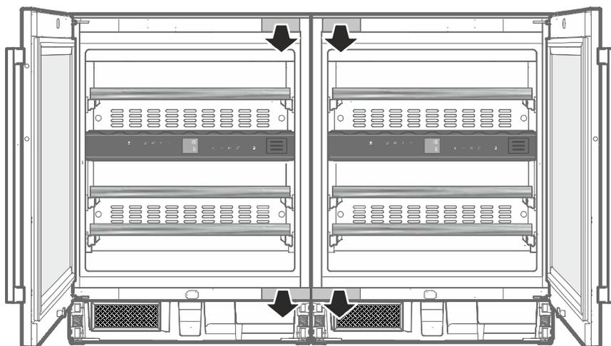
6. Nasadte horní spojovací úhelník.
