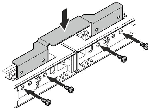
Sätt i fästvinkeln uppifrån och skruva fast med 4 st. M5 x 10-skruv (TX 25).
