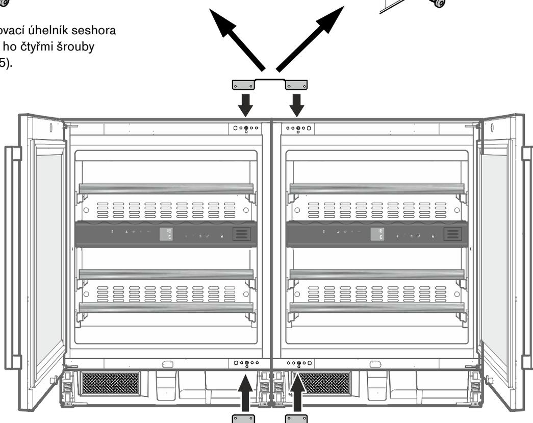
7. Druhý spojovací úhelník (bez upevňovacího úchytu) nasadte zespod a přišroubujte ho čtyřmi šrouby M5 x 10 (TX 25).
