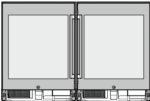
3. Aligner les appareils en hauteur et horizontalement.
