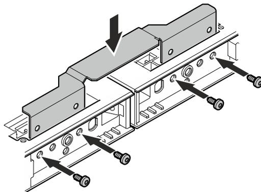
Τοποθετήστε τη γωνία σύνδεσης από επάνω και βιδώστε την με τέσσερις βίδες M5 x 10 (TX 25).
