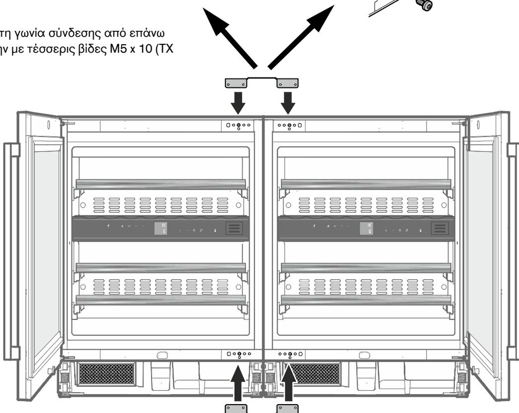
7. Τοποθετήστε τη δεύτερη γωνία σύνδεσης (χωρίς έλασμα στερέωσης) από κάτω και βιδώστε την με τέσσερις βίδες M5 x 10 (TX 25).
