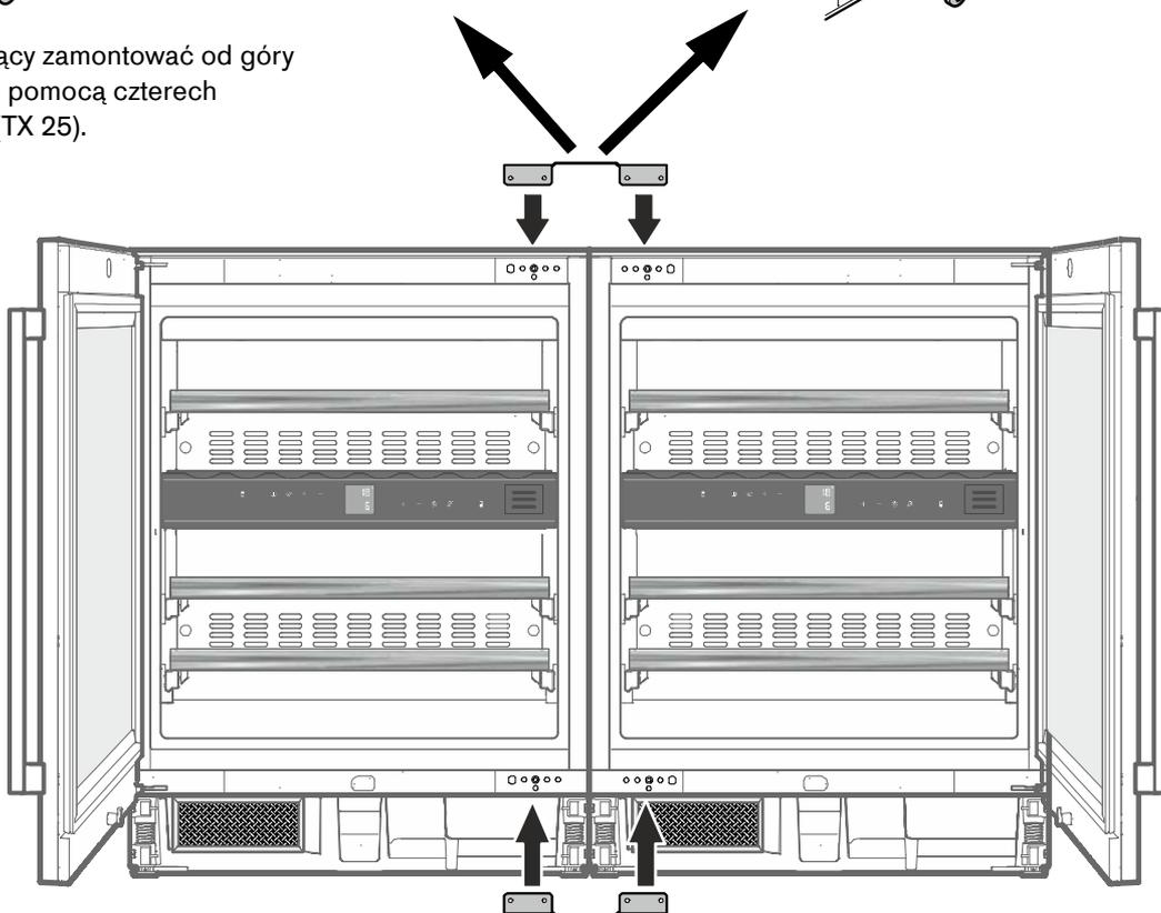
7. Drugi kątownik łączący (bez nakładki mocującej) zamontować od dołu i przykręcić za pomocą czterech śrub M5 x 10 (TX 25).
