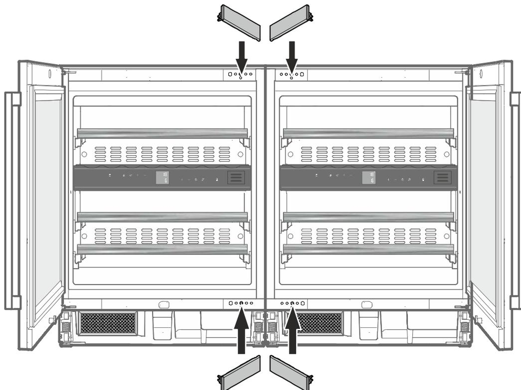
9. Kombinację urządzeń wsunąć we wnękę w taki sposób, aby przednia powierzchnia drzwi urządzenia znajdowała się w jednej płaszczyźnie z frontami mebli.
