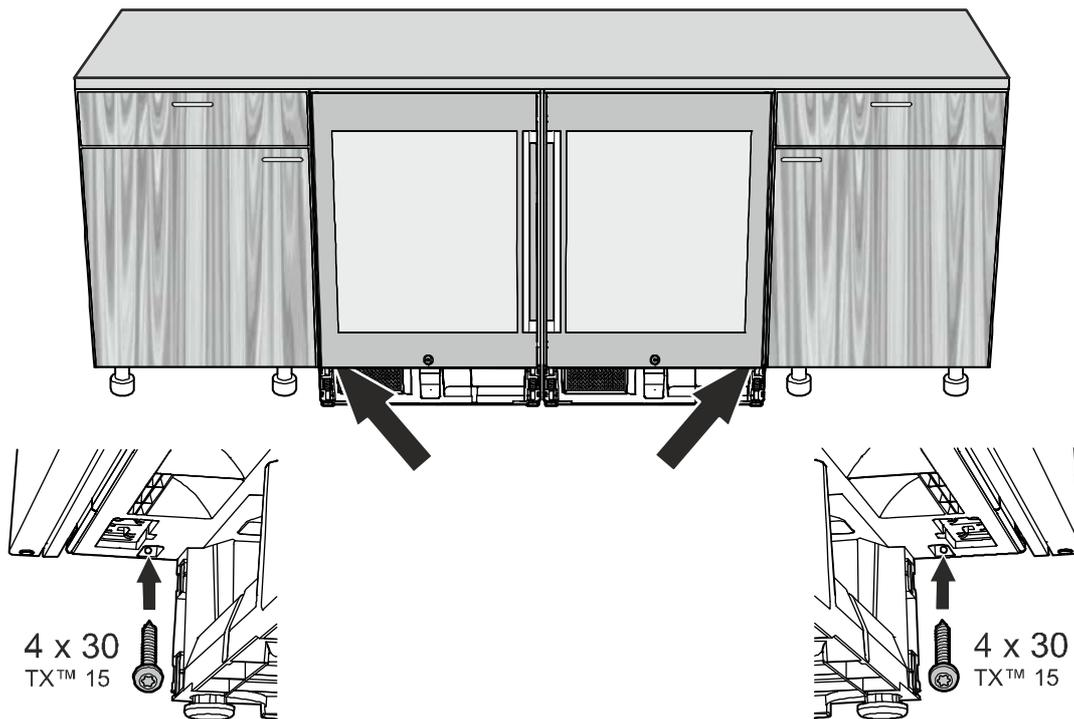
11. В случае с деревянными столешницами закрепите комбинацию приборов в нише сверху.
