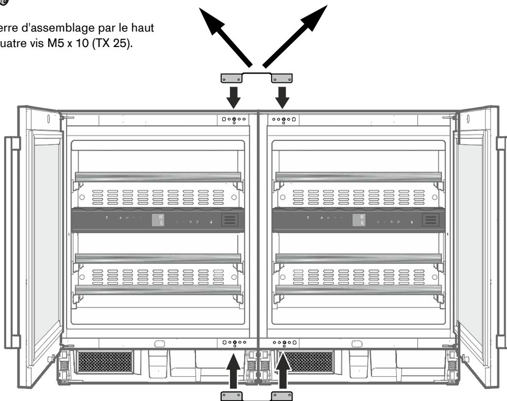
7. Installer la seconde équerre d'assemblage par le bas (sans bride de fixation) et serrer les quatre vis M5 x 10 (TX 25).
