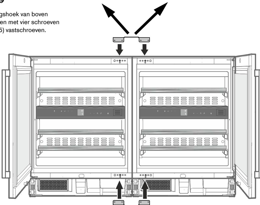
7. De tweede verbindingshoek (zonder bevestigingssoog) van onder er in brengen en met vier schroeven M5 x 10 (TX 25) aanschroeven.
