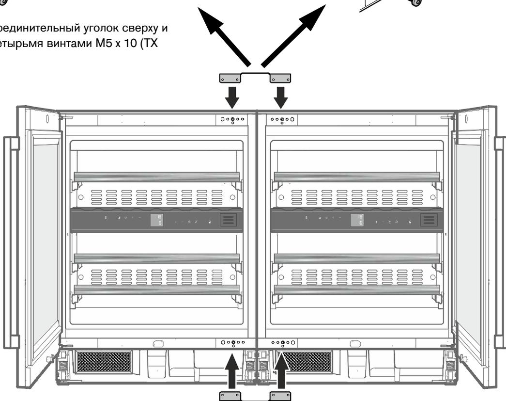
7. Установите второй соединительный уголок (без крепёжной лапки) снизу и привинтите четырьмя винтами М5 х 10 (ТХ 25).
