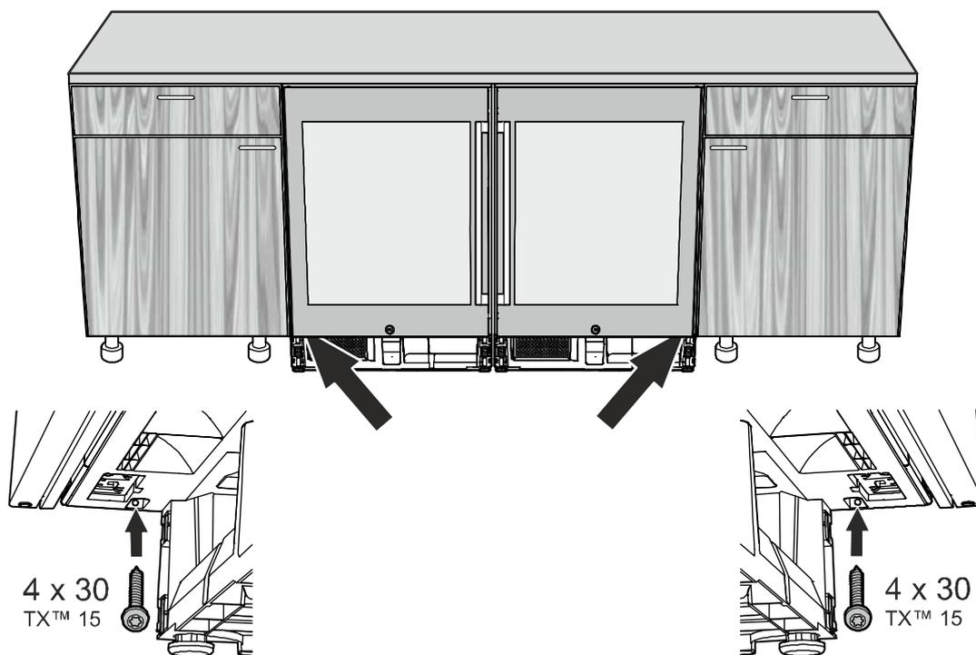
11. Bij werkbladen van hout de apparaatcombinatie in de nis boven bevestigen.
