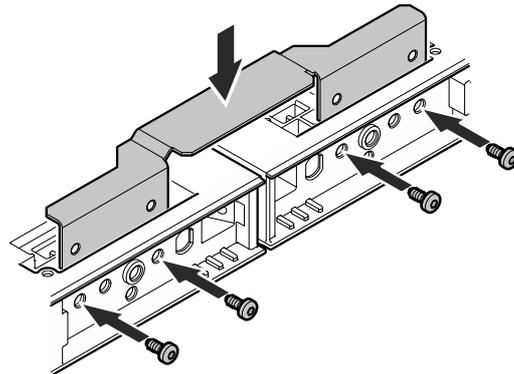
Installer l'équerre d'assemblage par le haut et serrer les quatre vis M5 x 10 (TX 25).
